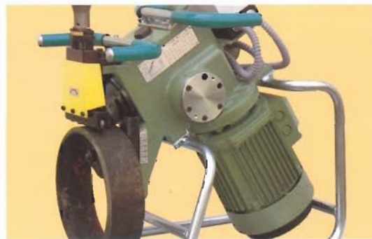
Vista de la máquina realizando la operación de chaflanado en tubos de distinto tamaño. View of the machine beveling tubes of different sizes. Vue de la machine en train de réaliser l'opération de chanfreinage sur des tubes de taille différente.
