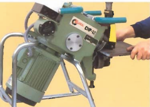
Ejemplo de chaflanado de piezas pequeñas multiformes. Examples of beveling multi-form little parts. Exemples de chanfreinage de petites pieces multiformes.
